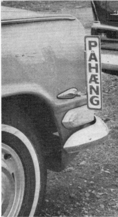
Denemarken houdt van veiligheid. Zo is er de de benijdenswaardige bepaling dat auto's met aanhangers op het rechterspatbord een bordje voeren, waarop elke wielrijder kan zien dat er behalve de auto ook nog een aanhangwagen of caravan passeert. Het bordje is inklapbaar.
