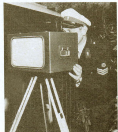
Wanneer de antenne met een hoek van 20° op het te controleren weggedeelte is gericht, werkt de apparatuur feilloos.
